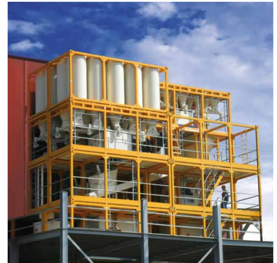
Сокращенное время монтажа: комплектный контейнерный завод, предварительно собранный и испытанный перед отгрузкой от изготовителя, обеспечивает уход от риска проблем в течение установки его на месте и сокращение времени монтажа от 70 до 80 %. Электрические системы, системы сжатого воздуха и управления являются нашей ответственностью.
